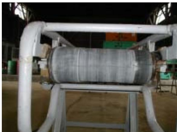
写真のように、テールローラーの真中にベルトがきて、左右が均等になれば、OKです。ベルコンの修理費の大半はベルト片寄りによる、ベルトの切断です。わずかな手間で簡単に調整出来ます。
