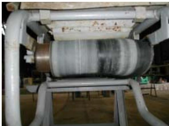
図の様にベルトが右側に片寄りしていると、フレームとベルトが擦れますので、**耳切れの原因**となります。片寄りの原因は、**ローラーへの土の付着、ベルトとトラフ板の間への土の詰まり**等があります。
